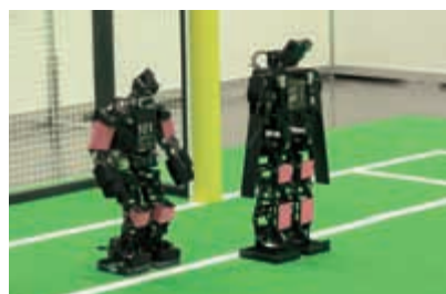
左が「CIT Brains」旧型機。右が新型機だ。現在のルールでは必要ない腕の自由度などを省略し、ロボカップに特化させたという。
