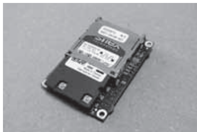
図2 KCB-3WLのCPUボード。SDカードのように見えているのは無線LANのユニット。
