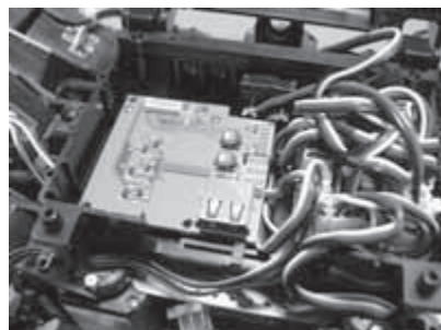
図4 近藤科学から発売されている「バックパックセットtypeA」にとりつけた電源基板。基板の右上で切欠きがスイッチを避けている。
