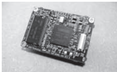
図3 CPUボードの裏面。中央にCPUが見える。右寄りにある白いコネクタで電源基板と接続する。
