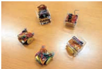
写真2 米国(Waiakera High School)のロボットたち。1インチのキューブに、CPUやセンサ、バッテリーをコンパクトに搭載。
