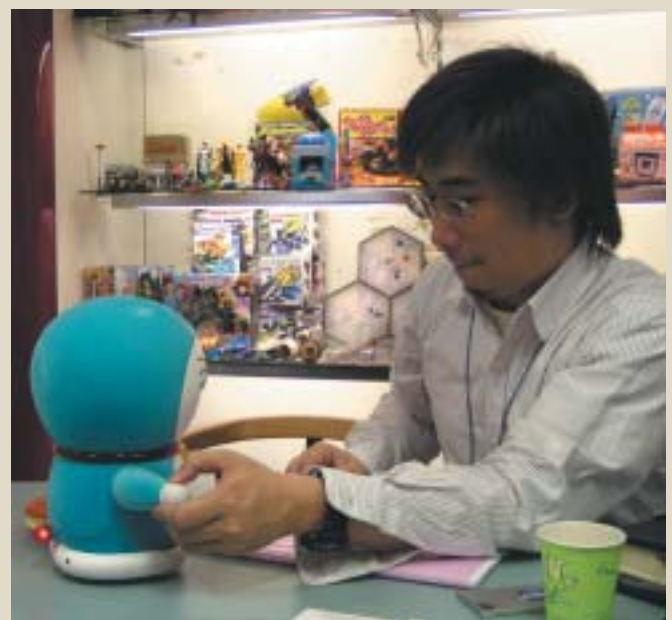
手がスイッチになっており、音声登録の際などに使用する
