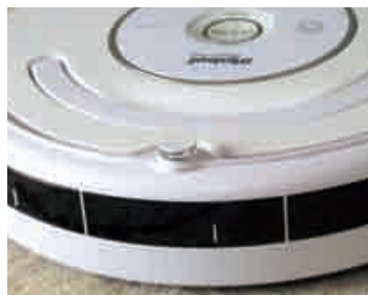
写真4 ルンバ本体の前面にあるバンパーと赤外線センサー
