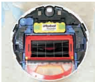
写真2 ルンバの裏側中央に、デュアルパワーブラシが配置されている(ボトムカバーを取り外した状態)。
