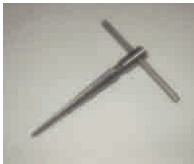
写真 15 エンジニア製のテーパリーマー。これは、3～12mm の穴をあけることのできる、TR-01。
