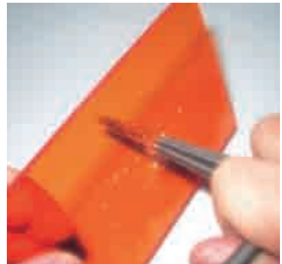
写真 17 その穴にリーマーを差し込んで、ぐりぐりと左右に動かしながら押し込んでいくと、どんどん穴が広がっていく。
