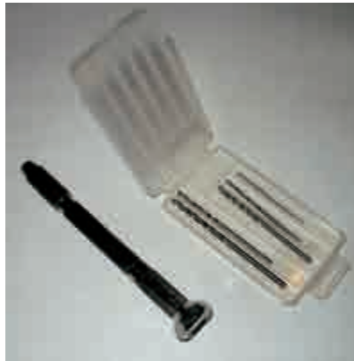
写真 13 タミヤ製の精密ピンバイス D とベーシックドリル刃セット。
