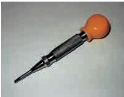
写真 12 柄を押さえつけると、先端に強い力が加わるタイプのポンチ。片手でも扱えるので便利だ。
