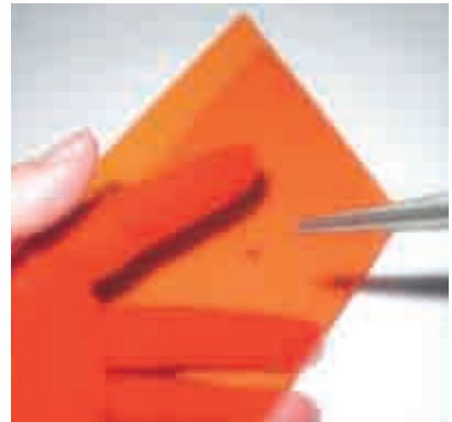
写真 16 リーマーの対応最小径の穴をあらかじめ空けておく。
